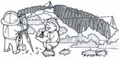
現在の地籍測量 （トータルステーションによる数値測量）
